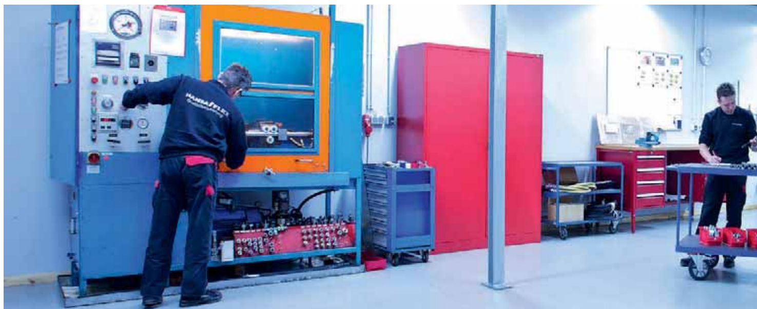
Blick hinter die Kulissen: Hydraulik-Druck-Impulsprüfung bei Hansa-Flex.
