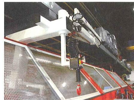
Die Bestückung des Prüfstandes durch eine Hebehilfe ermöglicht eine effiziente Einbindung in den Produktionsprozess
