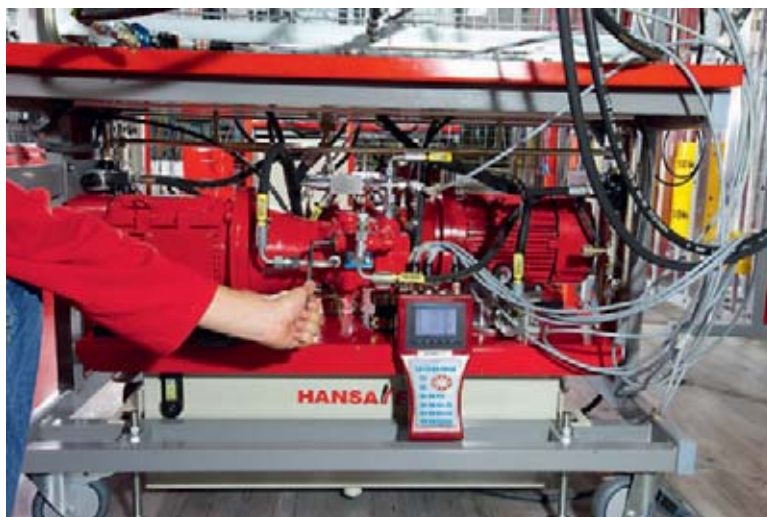
Das kontrollierte und korrekte Einstellen des Load-Sensing-Reglers lehren die Trainer am Schulungsstand der Internationalen Hydraulik akademie.
