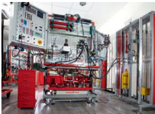
Das kontrollierte und korrekte Einstellen des Load-Sensing-Reglers lehren die Trainer am Schulungsstand der Internationalen Hydraulik akademie.
