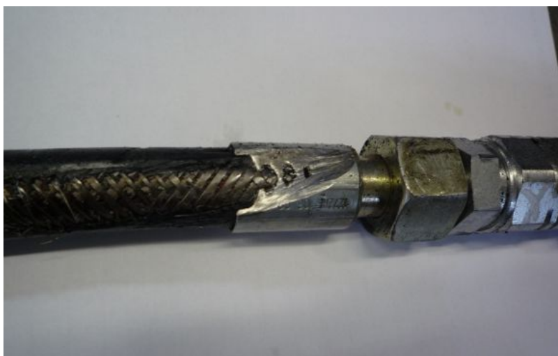
Durchgescheuerte Schlauchleitung: Reibstellen zwischen zwei Schläuchen oder an Rahmen und Energieführungsketten schadet den beteiligten Komponenten. Werden die Metallteile im Schlauch freigelegt, ist es nur eine Frage der Zeit, bis Korrosion die Schlauchleitung zerstört. Bild: IHA
