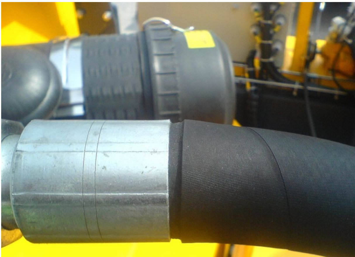
Das sieht nicht gut aus: Der Schlauch wandert aus der Fassung heraus. Bild: IHA
