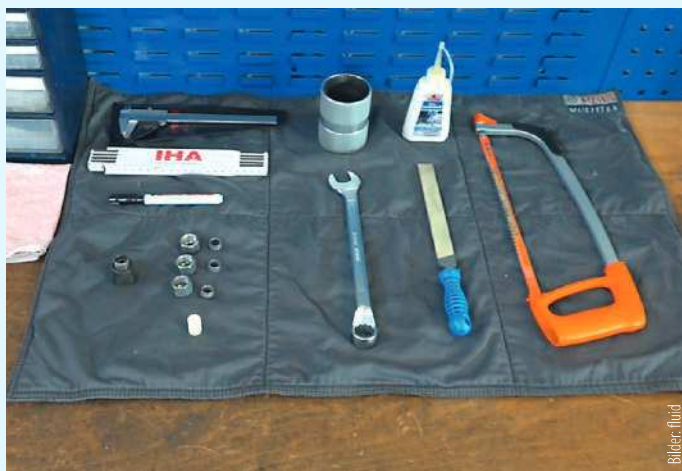
Mit diesem Werkzeug gelinge die Schneidring-Montage, erklärt Matthias Müller, Trainer bei der Internationalen Hydraulik Akademie Dresden.
