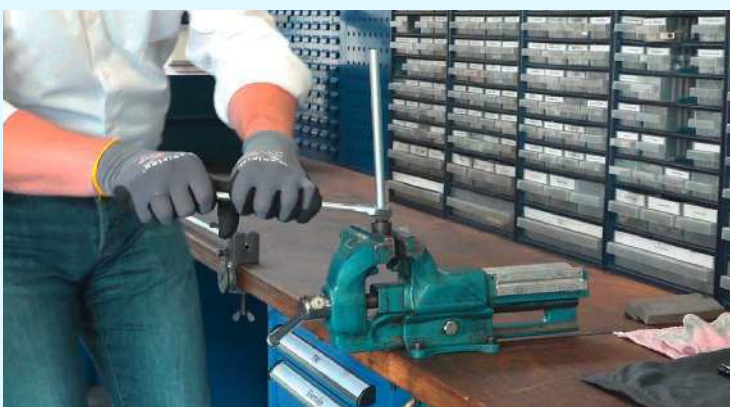
Beim Drehen gilt die Regel: Zu viel des Guten schadet der Verbindung und kann im schlimmsten Fall zu Leckagen führen.
