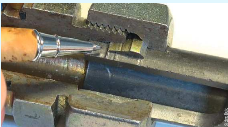
Achtung! Bei einer Übermontage kann es zu Aufwölbungen am Rohr kommen.
