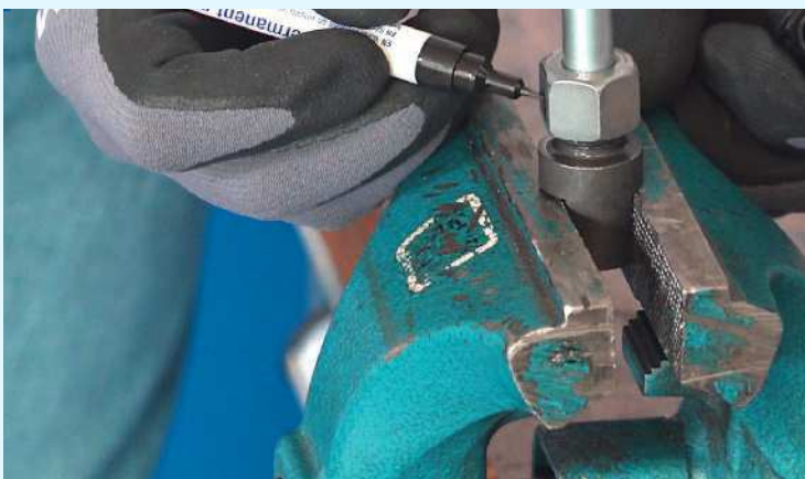
Schraubstock und Überwurfmutter müssen mit einem Strich markiert werden, damit man bei den einviertel Umdrehungen nicht durcheinander kommt.
