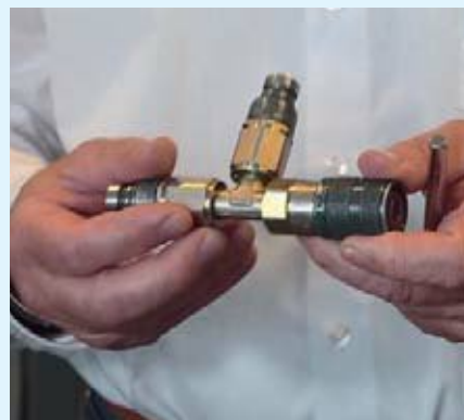
Mit der Kreuzverbindung, auch T-Stück genannt, wird der Volumenstrom des Hydrauliköls geteilt und durch zwei Wege in die Zylinderkolben gepumpt.
