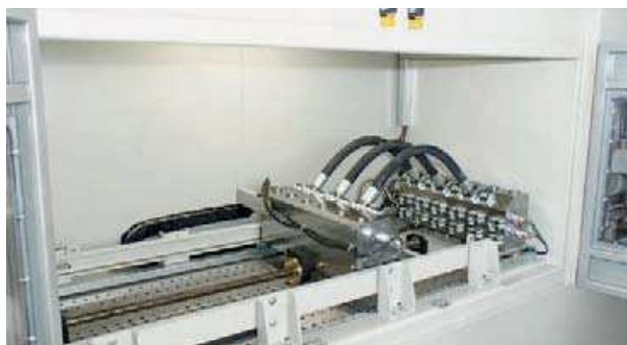
Mit dem Prüfstand kann die IHA nun auch Druckimpulsvibrationsprüfungen im eigenen Haus durchführen.
