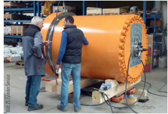
Spezialanfertigung: Kolbendurchmesser bis zu 10 Meter haben die Sonderzylinder von ZS Zylinder Service. Das Unternehmen registriert eine verstärkte Nachfrage nach Umweltverträglichkeit.
