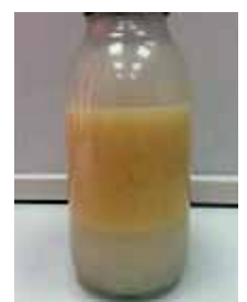
Hier ist das Öl mit Wasser kontaminiert – das Hydrauliköl ist milchig trüb. Auch das lässt sich bereits mit dem bloßen Auge erkennen.
