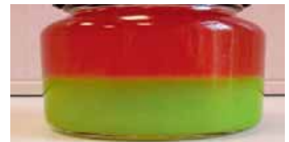
Durch eine unerlaubte Vermischung hat sich das Öl in einzelne Phasen getrennt.
