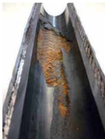
Hier ist die Innenschicht des Schlauchs durch den Sandstrahlereffekt abgetragen worden – der Verschleiß nimmt rapide zu, der Schlauch fällt aus.
