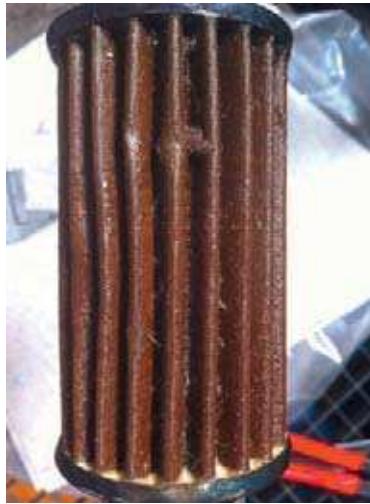
Bei der falschen Verwendung von HLPD Ölen werden die Filterelemente regelrecht mit Schmutz überschwemmt.
