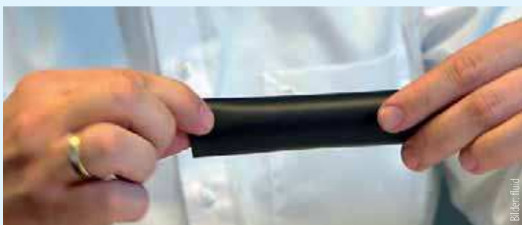
Falsches Dimensionieren kann eine ehemals flexible, elastische Schlauchleitung aushärten lassen.
