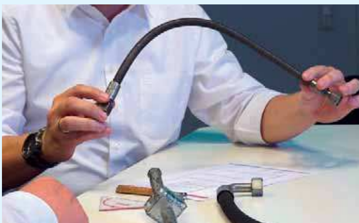
Falsches Dimensionieren kann eine ehemals flexible, elastische Schlauchleitung aushärten lassen.
