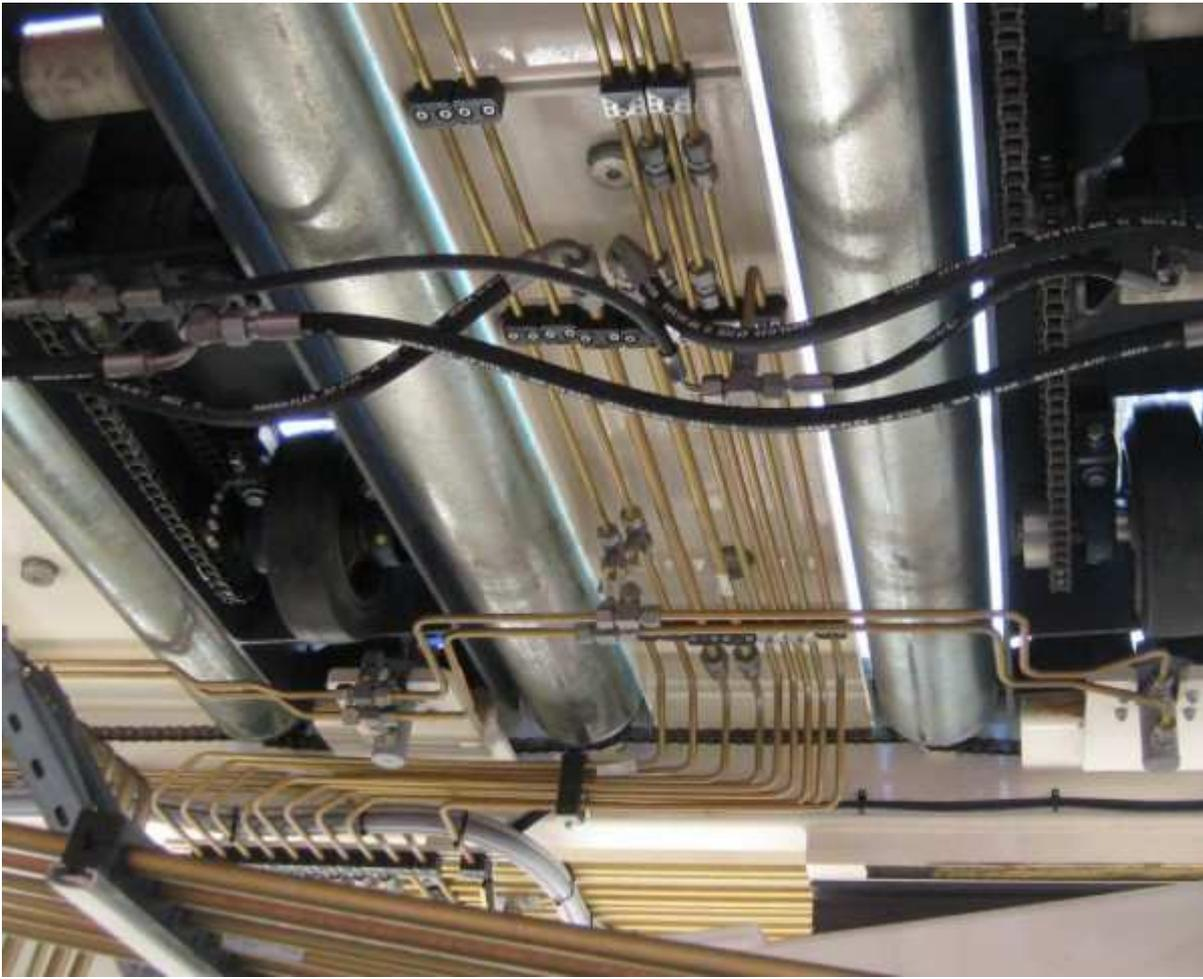
Beim Biegen nimmt die Wandstärke des Rohres auf einer der Außenseite ab. Ein gebogenes Rohr hat daher nicht die gleiche Druckfestigkeit wie ein gerades.
