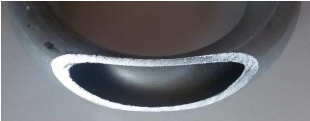
Beim Biegen nimmt die Wandstärke des Rohres auf einer der Außenseite ab. Ein gebogenes Rohr hat daher nicht die gleiche Druckfestigkeit wie ein gerades.
