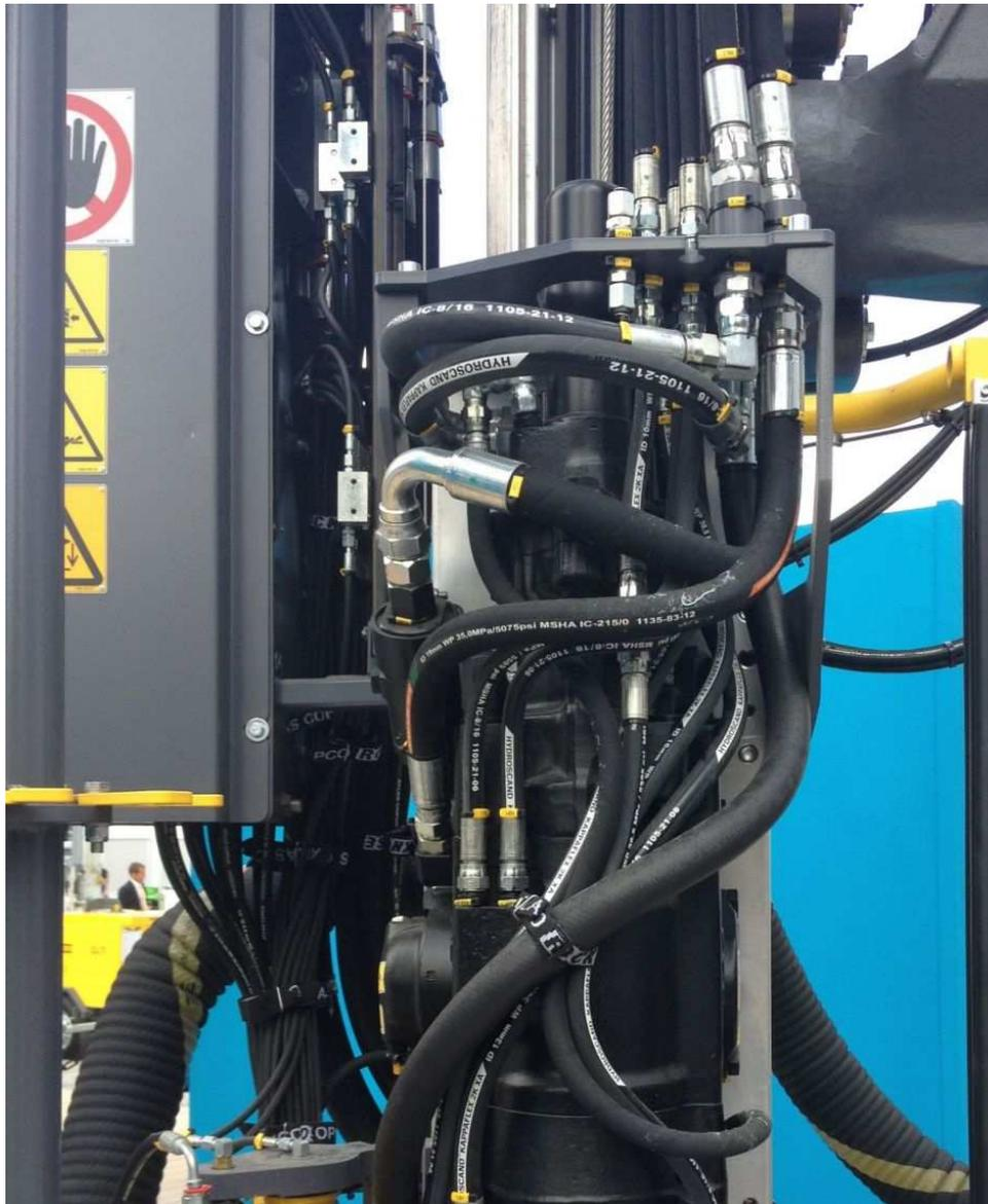
Schlauchleitungen müssen regelmäßig überprüft werden. Bild: IHA
