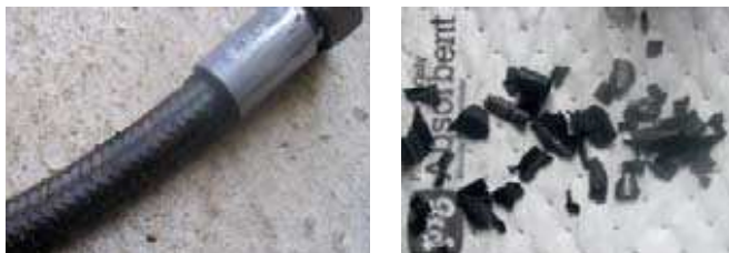
Durch die defekte Schlauchleitung am Druckanschluss der Pumpe, wurde das Fluid durch den Druckträger der Schlauchleitung direkt in den Tank gedrückt. Der Umstand, dass es hier auch noch zur Schaumbildung im Fluid kommt, ist bei diesem Schadensbild unerheblich.
